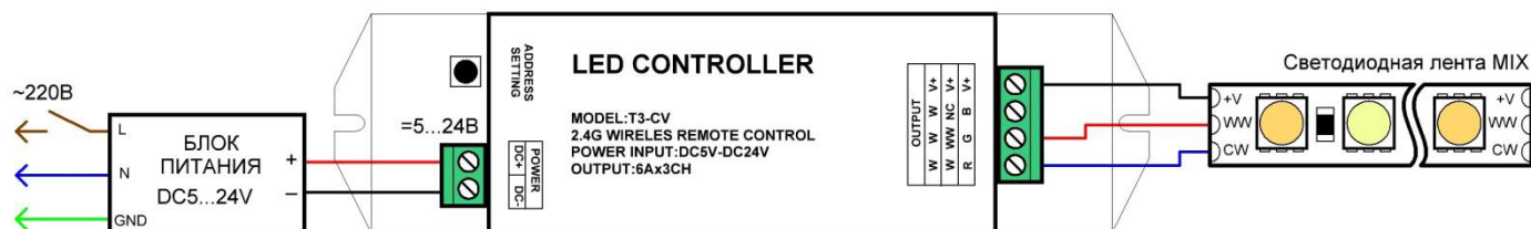
Рис.1. Схема подключения контроллера LT-T3-CV
